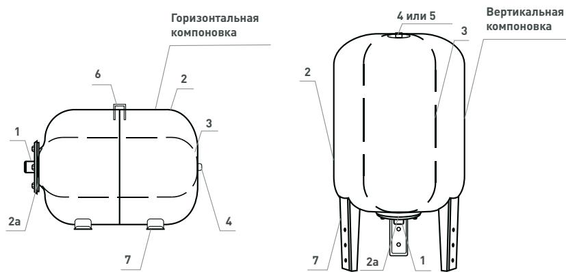
В исходном состоянии в гидроаккумулятор со стороны воздушного клапана закачан воздух до давления 1,5-2 атм. В рабочем состоянии со стороны штуцера фланца в мембрану гидроаккумулятора под давлением поступает вода, сжимая воздух, который в свою очередь выталкивает воду из мембранны при выключенном насосе и открытом водоразборном кране.
